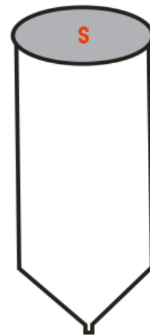
Figura 5 - Visualização da área de captação de chuva ( S ) em \text{cm}^2 no pluviômetro.
