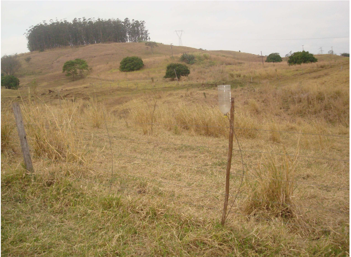
Figura 2 – Pluviômetro confeccionado com garrafa PET, instalado na área de estudo. Foto Meireles M, A; Agosto (2010)
